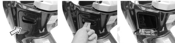
该摩托车配置有前货箱。要打开前货箱，就拉动前货箱盖的把手，然后打开前货箱。要关闭前货箱，推回前货箱盖，确保箱盖已经盖好。此前货箱的载重能力为1.5公斤。
