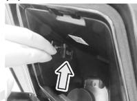
前货箱内，配有一个5伏(5V)的电源接口。打开防护胶盖就可以看到。发动机运转时，电源接口可以提供10瓦(10W)的电源输出。使用电器附件前，检查额定电压和功率是否符合要求。
