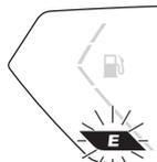
燃油表分6段显示。当6段均为实心框体时(见图20-01)，表示燃油已接近满箱。6段中仅剩1段实心框体且不断闪烁时(见图20-02)，表示油量已很低，此时燃油箱中剩下的油量大约为：1.2升，请尽快添加燃油。
