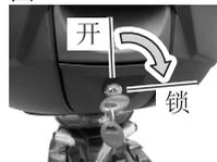
3. 按尾箱锁后面的按钮，将尾箱下压，装回到后货架上。
