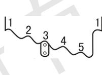
后减震器的缓冲弹簧, 可根据驾驶者的愿望、承载状况、驾驶方式和道路条件等因素加以调整。调整可任选五个位置之一, 只要把摩托车用停车架支稳后, 把弹簧调节器转到所需要的位置。第1位置最软, 第5位置最硬。本型号车出厂时都暂定在第3位置。
