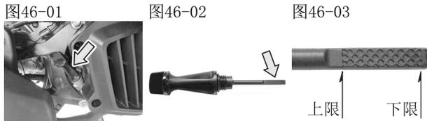
按照下列步骤检查发动机机油的油位。
