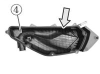
5. 清理空气滤清器壳体和空气滤清器盖④内的灰尘。
