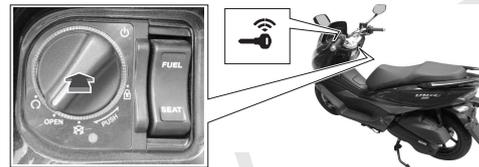
6. 安装输入模式接头①前，需要轻按点火开关，仪表上智能遥控器指示灯点亮。
