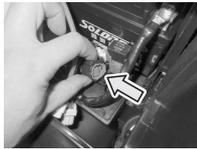
诊断接头在蓄电池的旁边。使用完毕后, 必须装回防护盖。
