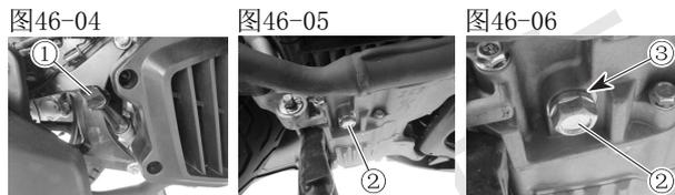
更换新的发动机机油应在发动机热机后进行，这样才容易把机内旧油全部放出。换油步骤如下：
