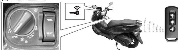
2. 按下点火开关, 智能锁系统识别智能遥控器后, 摩托车上的蜂鸣器响2次(蜂鸣器的声音可以消除, 见第9页), 摩托车解锁, 仪表上的指示灯和点火开关的指示环点亮。
