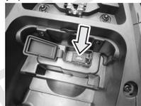
储物箱内，也配有一个5伏(5V)的电源接口。打开防护胶盖就可以看到。发动机运转时，电源接口可以提供10瓦(10W)的电源输出。使用电器附件前，检查额定电压和功率是否符合要求。
