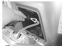
前货箱盖上的有一个胶塞，拆下胶塞，露出小孔。电器附件的线束可以通过此孔连接电源接口。
